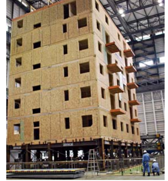
Une équipe de recherche regroupant plusieurs universités a placé ce bâtiment de sept étages sur la plus grande table de vibration au monde afin de l'exposer à la force d'un tremblement de terre frappant une fois à tous les 2,500 ans. Source de la photo : Université de l'État du Colorado
