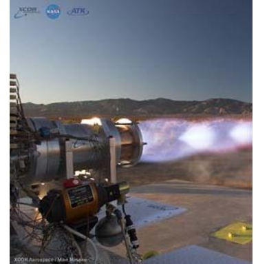
Prueba de puesta en marcha de un motor de LOX/metano con 7,500 libras de tracción. Crédito de la imagen: Mike Maseel/XCOR Aerospace
