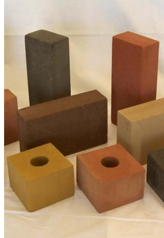
Los ladrillos de cenizas volátiles son una posible alternativa "ecológica" a los ladrillos de arcilla. Crédito de la imagen: Henry Liu, Freight Pipeline Company
