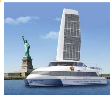
Ferry hybride dernier cri de la société Circle Line propulsé par l'énergie solaire et éolienne appelé Mlle Statue de la liberté.
