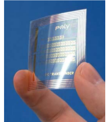
Modèle d'une étiquette en polymère flexible RFID. (Source de l'Image: PolyIC press picture)
