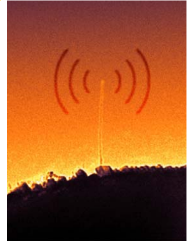
Esta imagen, tomada con un microscopio de transmisión de electrones, muestra un nanotubo individual de carbono que sobresale de un electrodo. Las ondas se agregaron como efecto visual. Créditos: Grupo de Investigación Zettl, Laboratorio Nacional Lawrence Berkeley y Universidad de California en Berkeley
